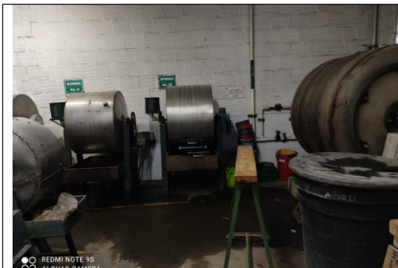
Foto 5. Zona de Teñido, la empresa vendió 4 fulones quedando con 8 fulones,
